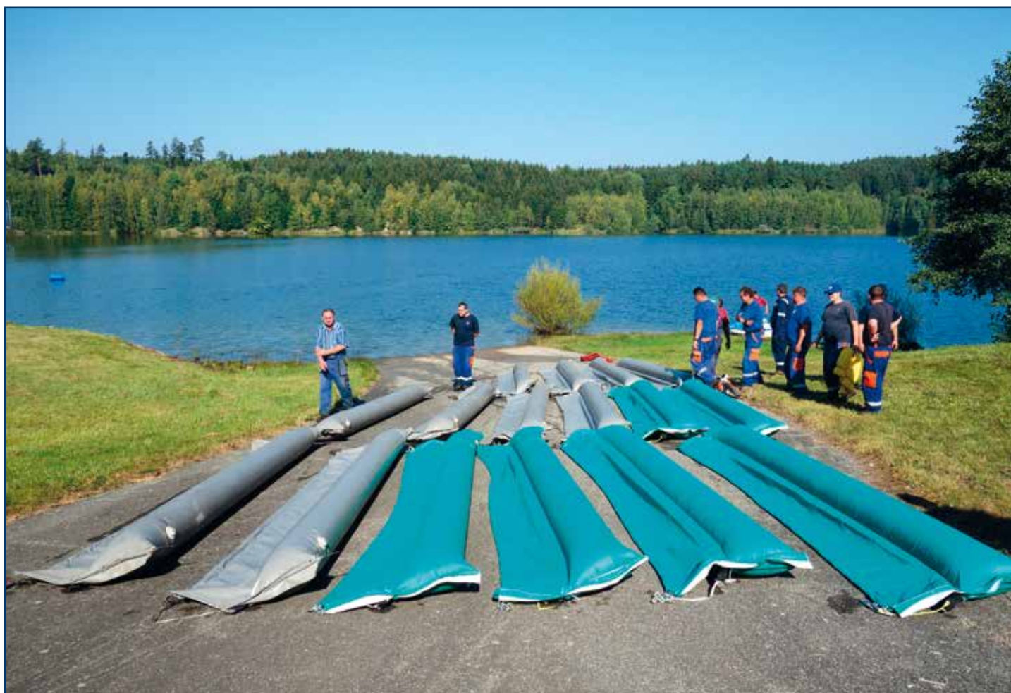
Na VD Boskovice je připraveno k použití 16 ks norných stěn
